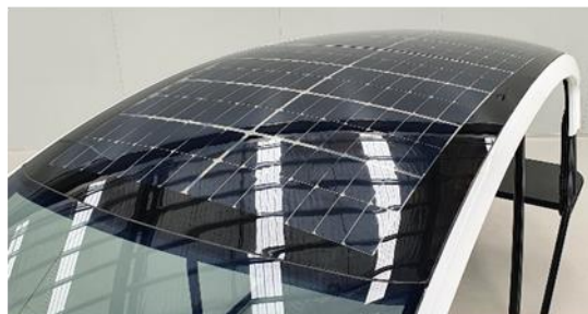
左：搭载了共同开发的光伏车顶的 AEV 公司制造的 LS-EV 原型车 右：光伏车顶
