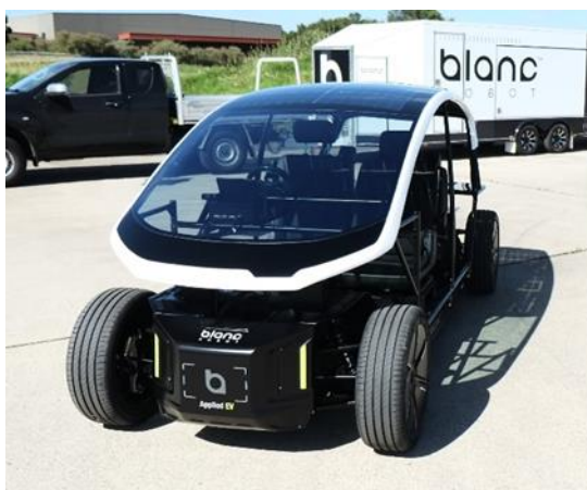
左：搭载了共同开发的光伏车顶的 AEV 公司制造的 LS-EV 原型车 右：光伏车顶
