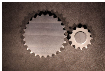
使用了“SOLFIGA®”的齿轮（试制品）
